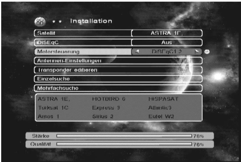
Zur Installation eines DiSEqC1.2- Motors wählen Sie im Untermenüpunkt „Motorsteuerung“ die Auswahl „DiSEqC1.2“ und bestätigen Sie mit der OK-Taste.
