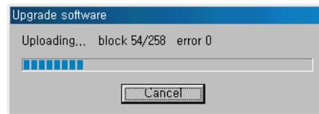
4. Nach der Beendigung der Übertragung warten Sie bis die Meldung "THE SOFTWARE UPGRADED SUCCESSFULLY" am PC erscheint und in der Geräteanzeige "good" steht. □ □ " □ □
